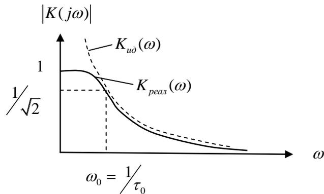
Приближенное интегрирование  $RC$ -цепью будет выполняться тем точнее, чем больше относительная доля высокочастотных составляющих в спектре сигнала. Другими словами, условие  $\omega\tau_0 \gg 1$  должно выполняться для всех частот, в том числе и для самых низких.
